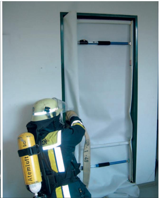
**links:** Mithilfe des mobilen Rauchverschlusses können die Luftströmungen leicht sichtbar gemacht werden.
