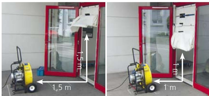
**links:** Bei einer lichten Höhe der Zuluftöffnung von rund 1,5 Meter sollte der Abstand des Belüftungsgerätes ebenfalls 1,5 Meter betragen. **rechts:** Bei einer geringeren Höhe ist auch der Abstand zwischen der Zuluftöffnung und dem Belüftungsgerät entsprechend zu verringern.
