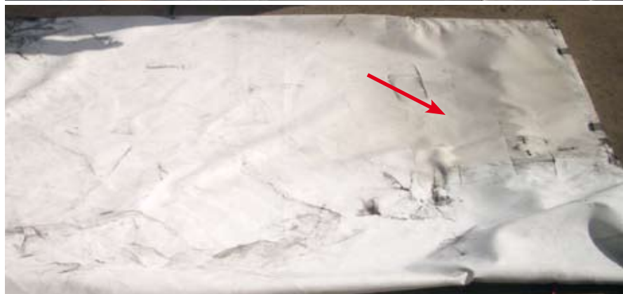
links: Eingesetzter Rauchverschluss bei den Brandversuchen an der LFS rechts oben: Brandversuch bei IFRT: Trotz Belüftungsgerät kam es ohne Mobilem Rauchverschluss zu einer Rauchausbreitung aus dem Brandraum in den Vorraum. rechts unten: Erkennbare Verschmutzung des Rauchverschlusses im oberen Drittel, die durch das Zurückhalten der Rauchgase bei den Versuchen bei IFRT verursacht wurde.
