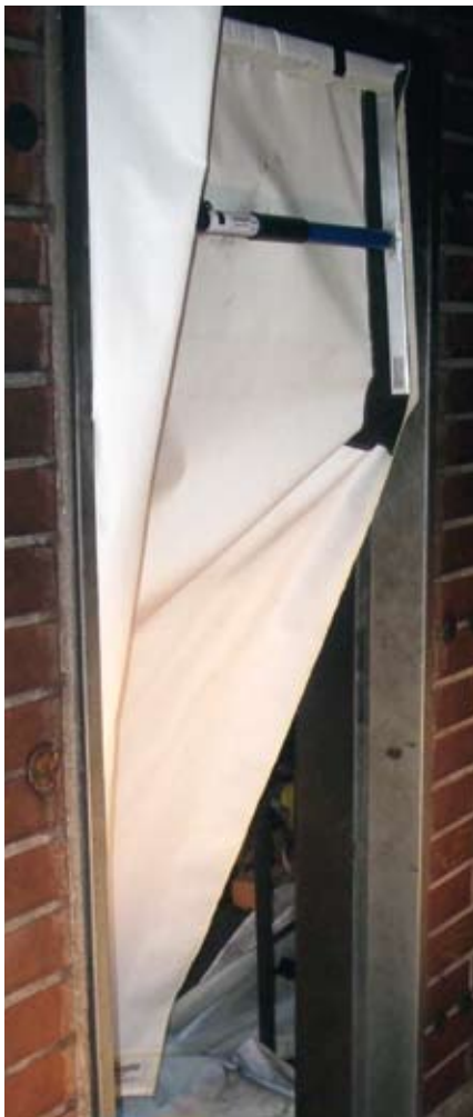
links: Eingesetzter Rauchverschluss bei den Brandversuchen an der LFS rechts oben: Brandversuch bei IFRT: Trotz Belüftungsgerät kam es ohne Mobilem Rauchverschluss zu einer Rauchausbreitung aus dem Brandraum in den Vorraum. rechts unten: Erkennbare Verschmutzung des Rauchverschlusses im oberen Drittel, die durch das Zurückhalten der Rauchgase bei den Versuchen bei IFRT verursacht wurde.
