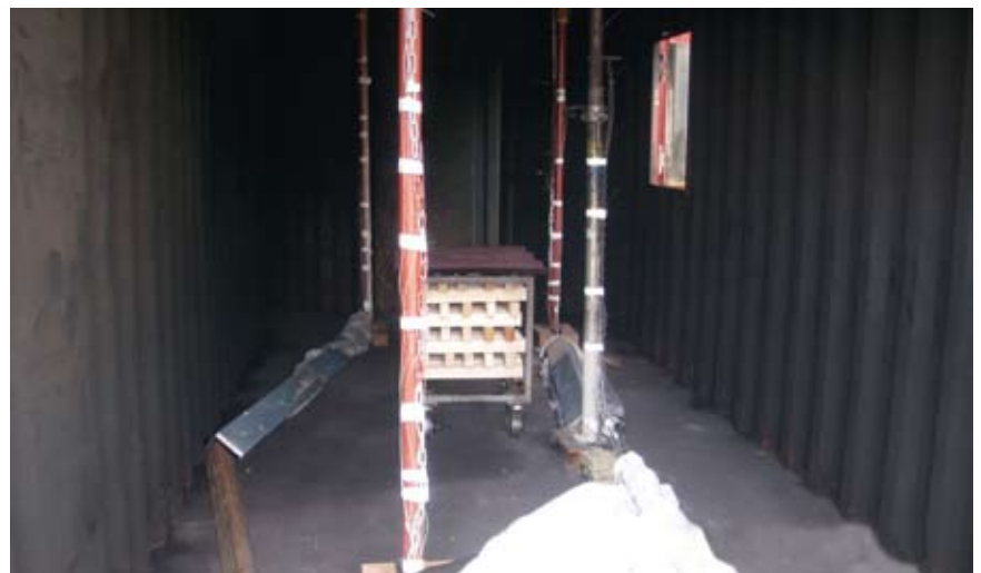
Blick in den »Brandraum« bei IFRT: Erkennbar sind die vier Messbäume sowie die Holzkrippe.
