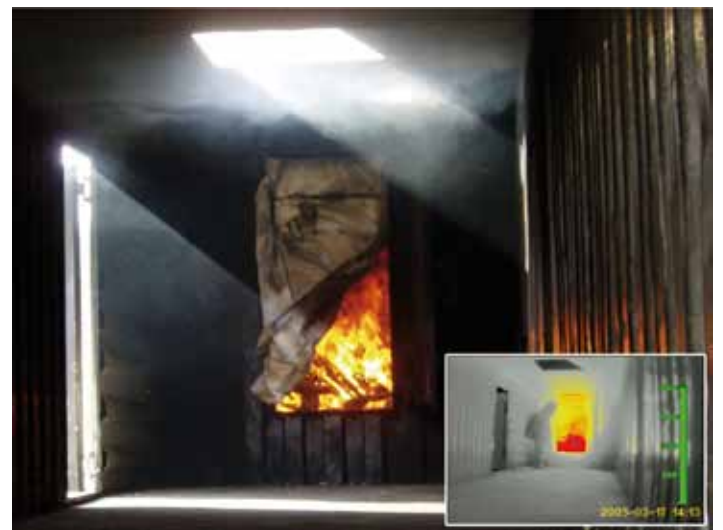
Der mobile Rauchverschluss im Brandversuch
